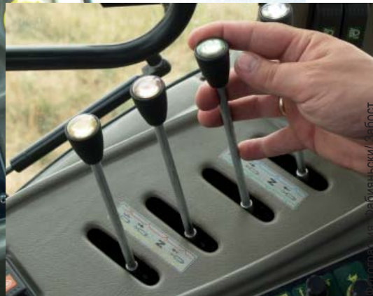
Фотография: Между правым крылом и сиденьем оператора находятся рычаги управления ВОМ, а также рычаг редуктора ползущих передач
