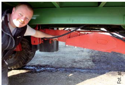
Фотография: Дышло с амортизированной пластинчатой рессорой
