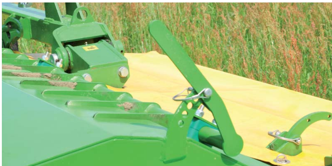
Фотография: Регулировка амортизации при проходе покоса
