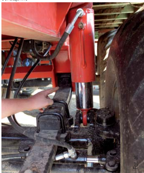
Фотография: В пустом прицепе первая ось может быть поднята, что уменьшает износ шин и расход топлива. Для подвески трех осей используются гидроцилиндры. Уровень амортизации можно регулировать
