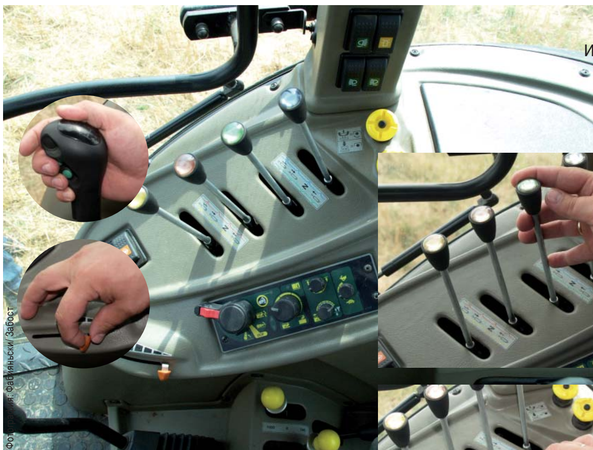
Фотография: На правом крыле находится большинство рычагов и электрогидравлических переключателей, управляющих системами трактора. Подъемное устройство обслуживается с удобной панели управления, оборудованной EHR
