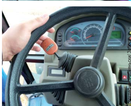
Руль регулируется на двух уровнях. Слева находится гидравлический реверс
