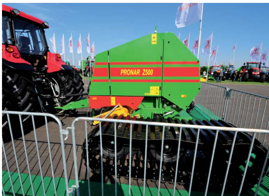
Фотография: Пресс-подборщик Z500 с гусеницами, позволяющими легко передвигаться по водно-болотным угодьям
