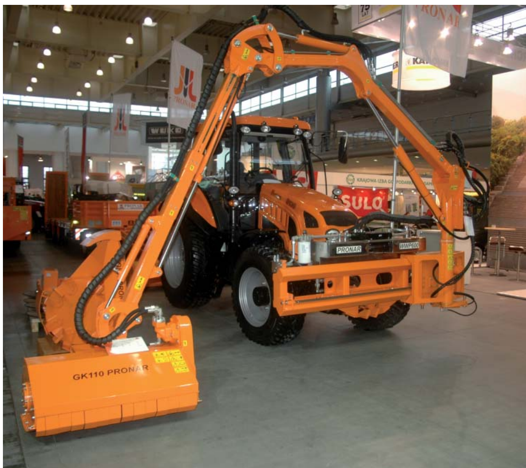
Фотография: Трактор PRONAR 5135, оснащенный многофункциональной выдвигной консолью PRONAR WWP 600 с агрегированной косящей головкой PRONAR GK110
