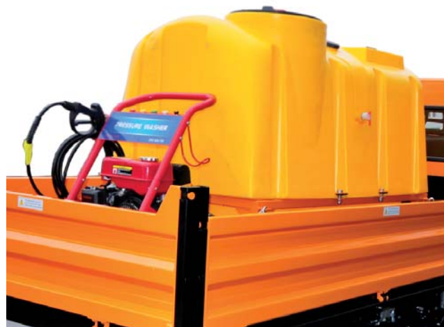
Фотография: Бак для воды и мойка высокого давления
