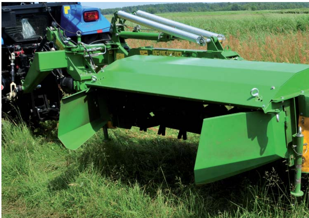
Фотография: Регулируемые металлические гребатели покоса
