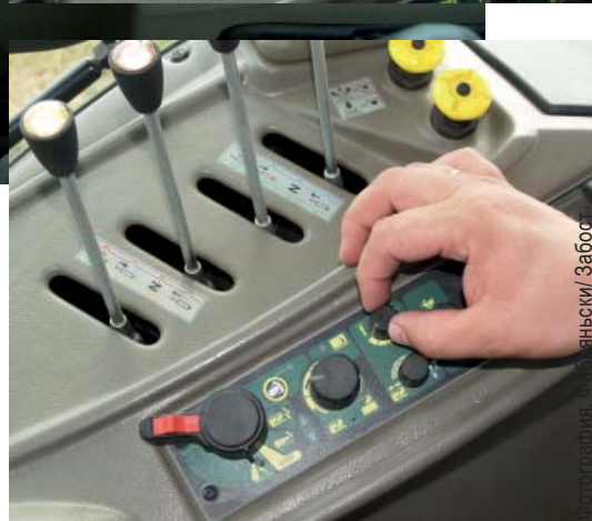
Фотография: На правом крыле находится большинство рычагов и электрогидравлических переключателей, управляющих системами трактора. Подъемное устройство обслуживается с удобной панели управления, оборудованной EHR
